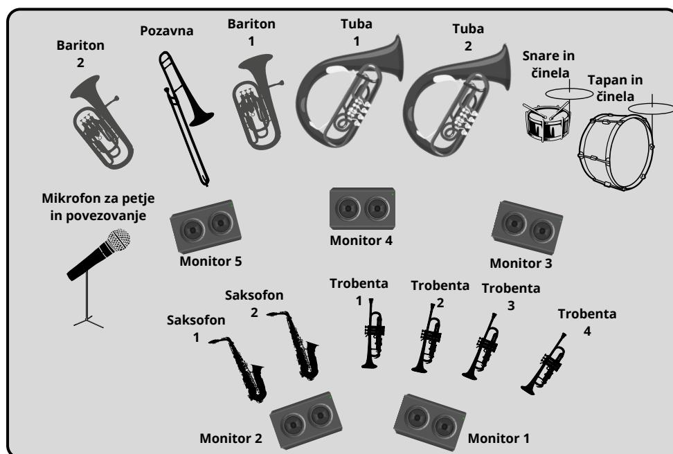
Vsi nastopajoči potrebujejo primeren mikrofon, idealno kondenzatorski clip-on (npr. AKG C419) dodatno pa še en mikrofon za povezovanje in petje. Samo tuba 1 ima za zasilne primere lastni dinamičnimikrofon AKG D112 (rabi XLR priključek).
